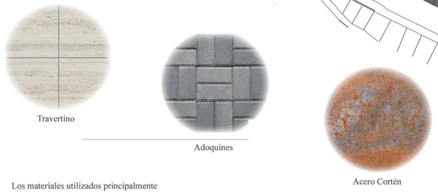
Los materiales utilizados principalmente son el travertino para el pavimento de la Calle Real, ya utilizado en algunas aceras de la misma, el adoquinado gris para la Calle Antequera y el acero cortén para el mobiliario urbano situado en la calle.
