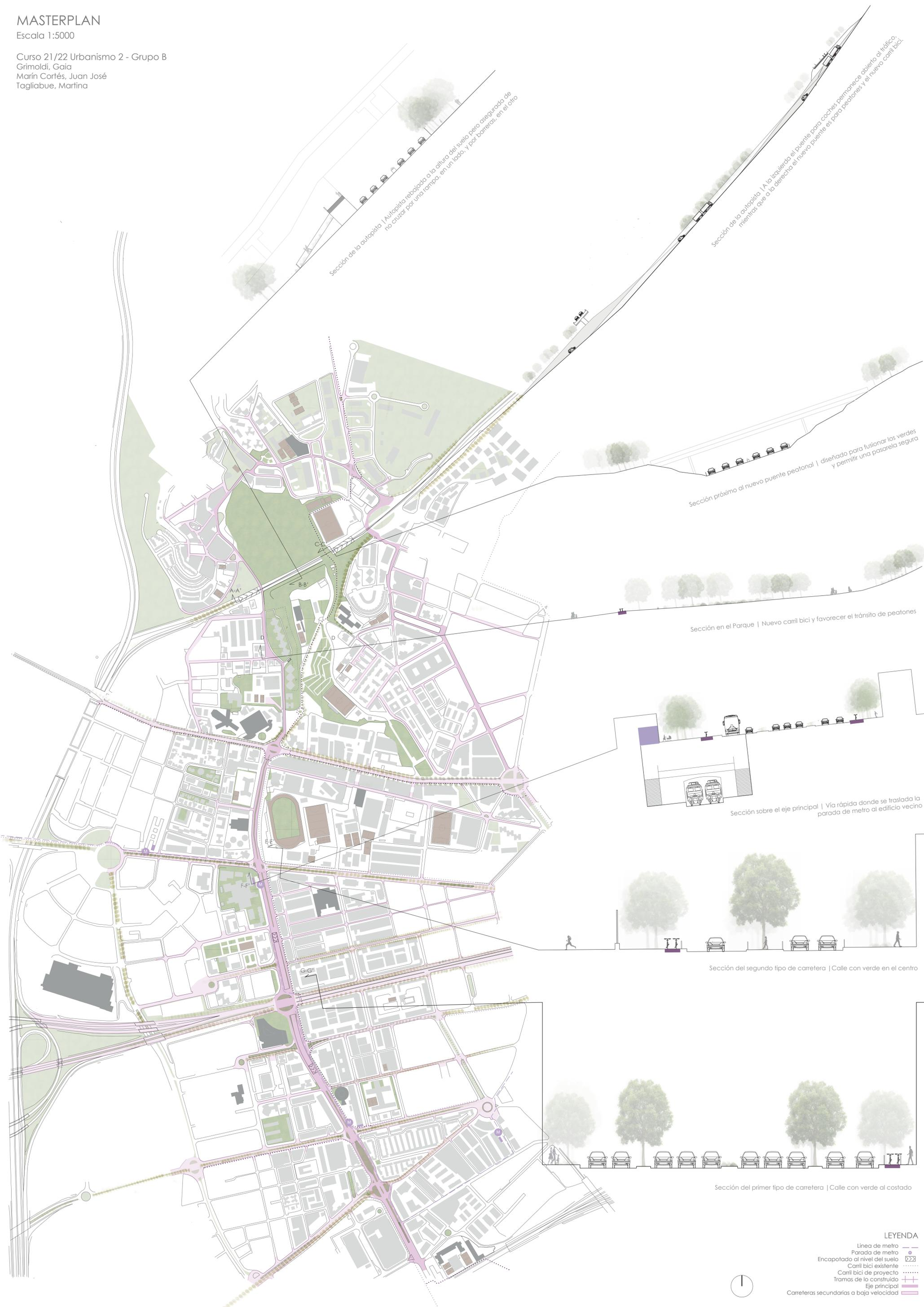
Sección de la autopista | Autopista rebajada a la altura del suelo pero asegurada de no cruzar por una rampa, en un lado, y por barreras, en el otro
