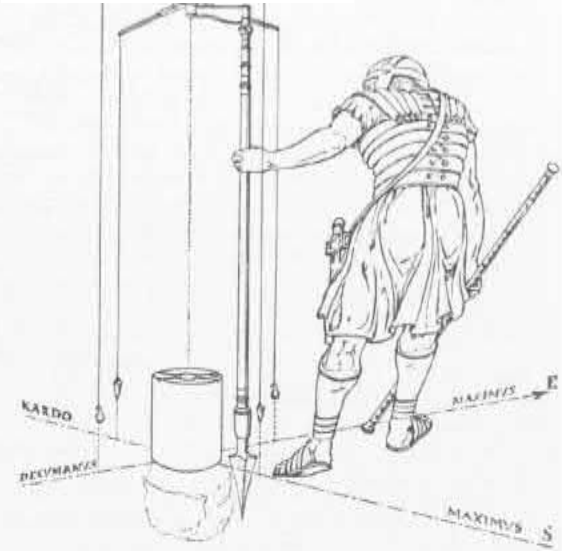
Fig. 331. La «groma», que servía para trazar las alineaciones perpendiculares de la «centuriatio» y de los planos de la ciudad. Estaba formada por cuatro listones de madera, de una longitud aproximada de 45 cm, que sostenían cuatro plomadas; el asta que los sostenía era plantada en el terreno de modo que el centro se encontrara en la vertical del círculo grabado en la piedra.
