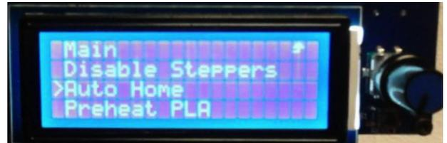
2\_ antes de comenzar, y con la impresora en la altura  $Z = 0$ , desactivamos los motores para poder desplazar manualmente el extrusor
