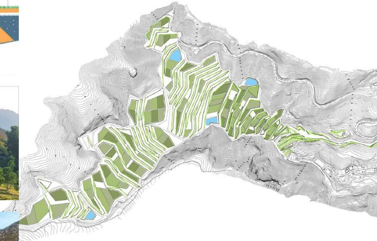
Las terrazas, los taludes y las rampas que conformaban la topografía de la explotación se respetaron y consolidaron con rellenos de materia inerte.
